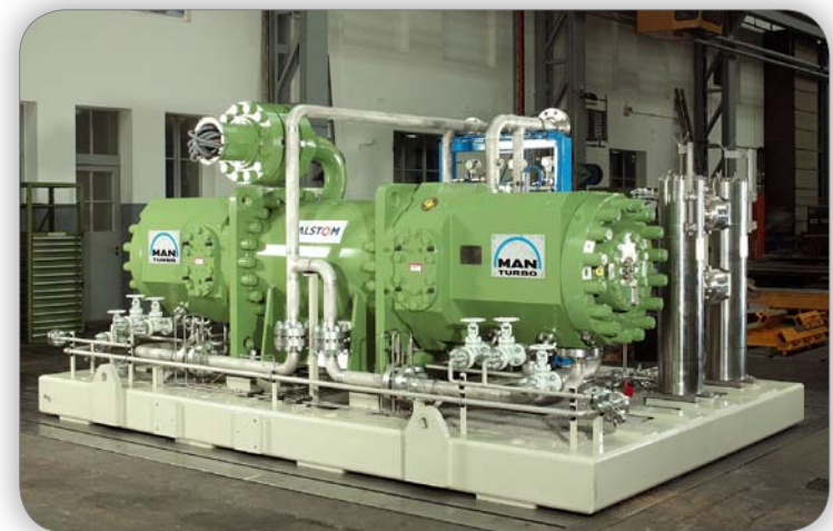
Man Turbo HOFIM™ Compressor estanque em configuração dupla com motor de alta velocidade Converteam (aplicação : instalação de armazenamento de gás Nüttermoor, Alemanha)
