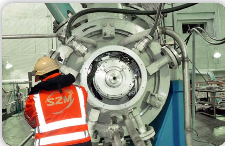
Vista do compressor a partir da extremidade sem transmissão durante a fase de montagem na oficina OEM.
