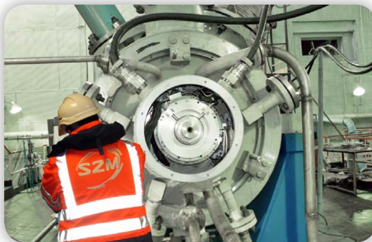
在OEM车间装配阶段，从无驱动装置一侧看过去的压缩机概貌
